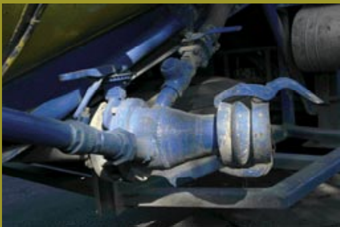
Sistema de descarga central con válvulas de seguridad y retenimiento.
