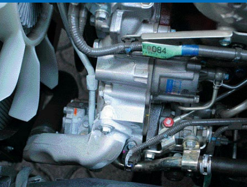
Bombas de dirección, vacío frenos y de alta presión de inyección, accionadas por engranaje desde la distribución. Ofrecen más seguridad a los sistemas.
