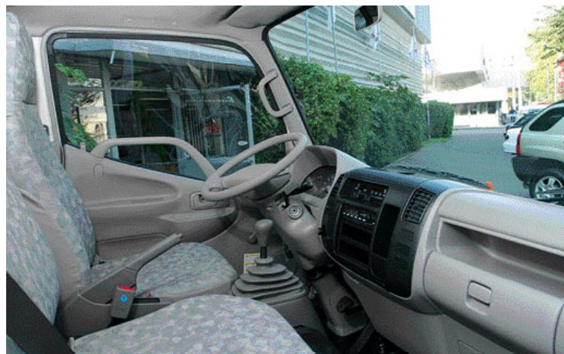
Amplia cabina, incorpora volante de absorción de impacto y columna colapsable.
