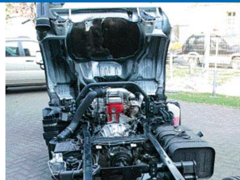
Cabina abatible, con fácil acceso al mantenimiento y rigidez que absorbe la energía del impacto.
