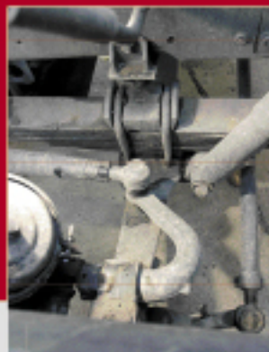
Eje delantero con PBT Técnico de 6.500 Kg.
