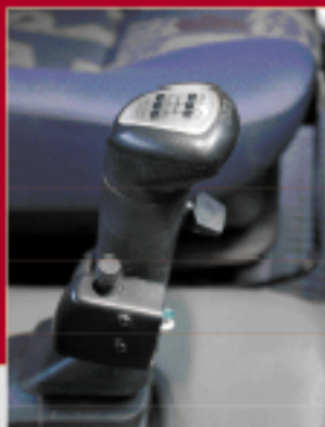
Caja de cambios Eaton RT 11710B de 10 velocidades. Excelente desempeño para altas exigencias. Primera velocidad de relación 14,78:1, y décima velocidad con relación directa 1:1.
