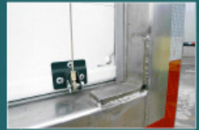
En los vértices del cuadro trasero fabricado en acero inoxidable, tiene 4 refuerzos. El sistema de roll up está accionado por pletas de acero.
