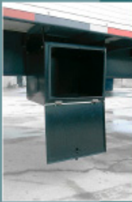
Caja de herramientas Altura: 500 mm. Ancho: 615 mm. Largo: 600 mm.
